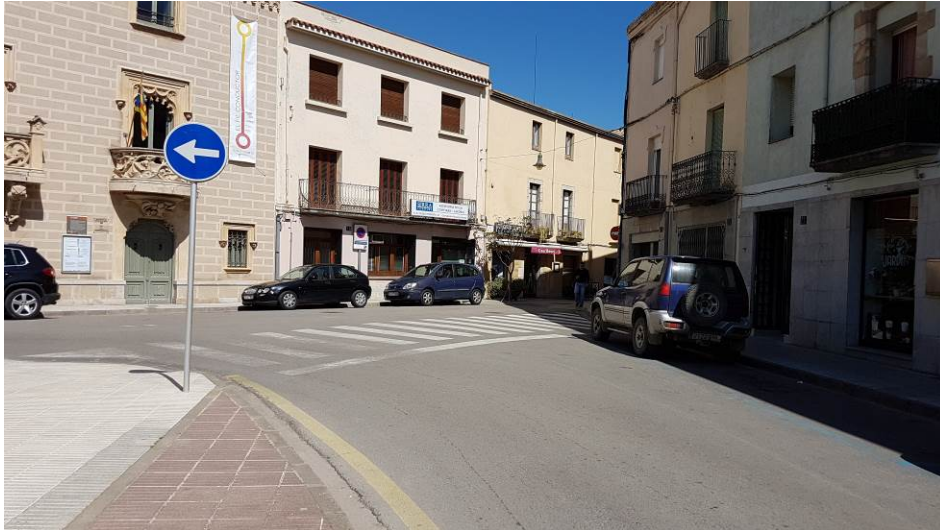
Fotografia 3.1.2.5 - Exemple de pas amb mala visibilitat
