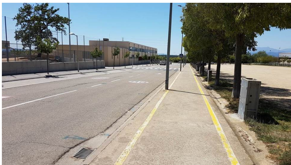
Fotografia 4.4.2.12 – Solució incorrecta: vorera destinada exclusivament per a ciclistes
